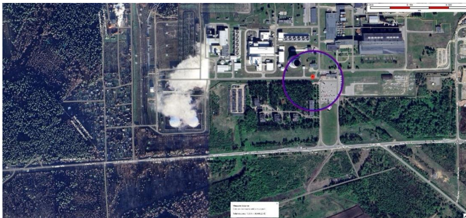
21. attēls: Ar TEC-2 saistītā noplūdē metāna ugunsstrūklas izraisītas 1% letalitātes varbūtības attālums (vēja ātrums 2 m/s un 5 m/s).
