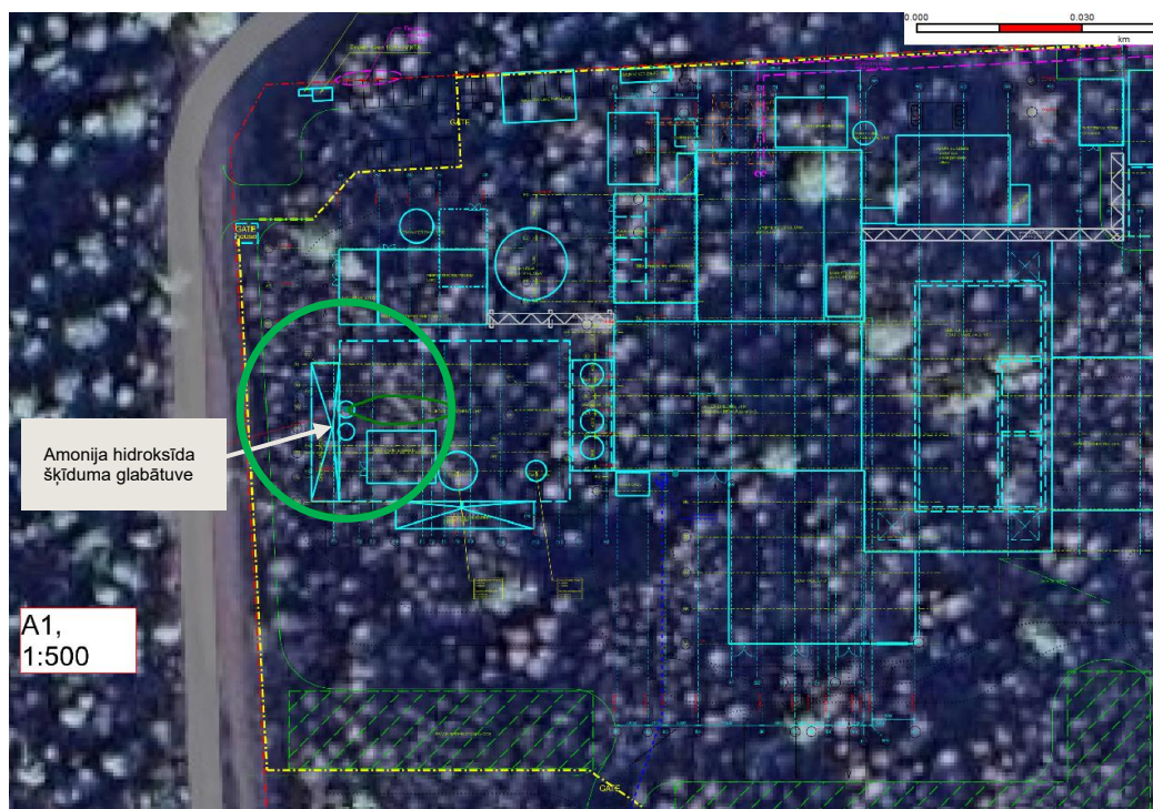
10. attēls. Attālums (zaļš = 19 m) līdz 1 % letalitātei no amonjaka izkliedes vietas ar vēja ātrumu 5 m/s. Mazākais zaļais laukums parāda varbūtību tikai ar vienu vēja virzienu (vējš no rietumiem uz austrumiem).
