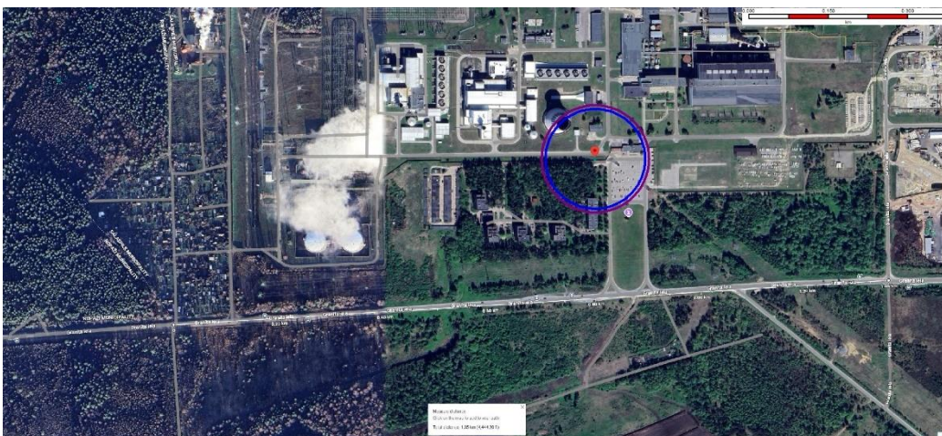
18.attēls: Ar TEC-2 noplūdi saistīts metāna dispersijas mākonis kā 100% zemākā uzliesmojamības robeža (44 000 ppm), kas redzama iepriekš.
